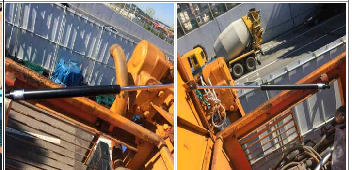
8톤살포기(2호) / 엔진룸 가스쇼바(운,조) 교환 후
