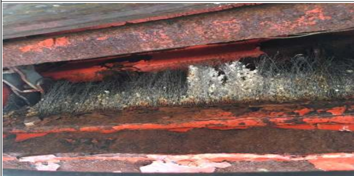
15톤살포기(6호) / 체인브러쉬(상,하) 교환 전
