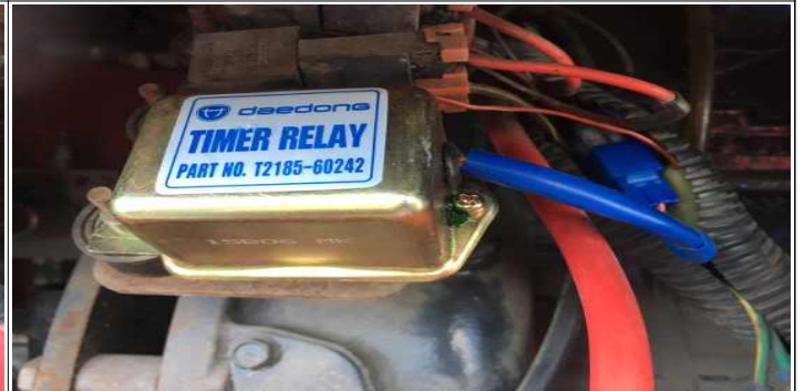
15톤살포기(2호) / 타임릴레이 교환 후
