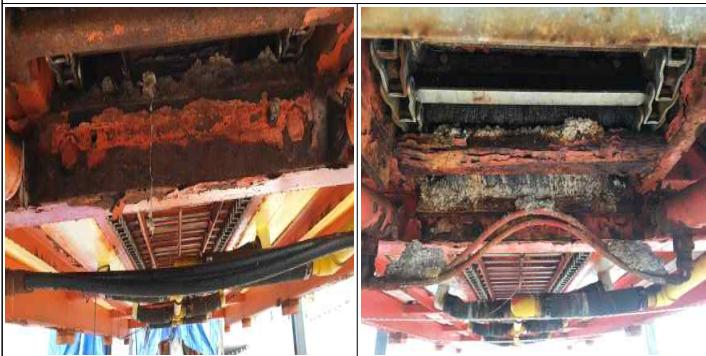
15톤살포기(5호) / 체인브러쉬(상,하) 교환 전
