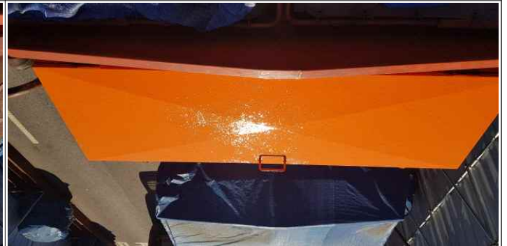
15톤살포기(1호) / 엔진룸 도어 사상 및 도장 후
