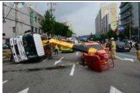
크레인 전복 사진(정면)
