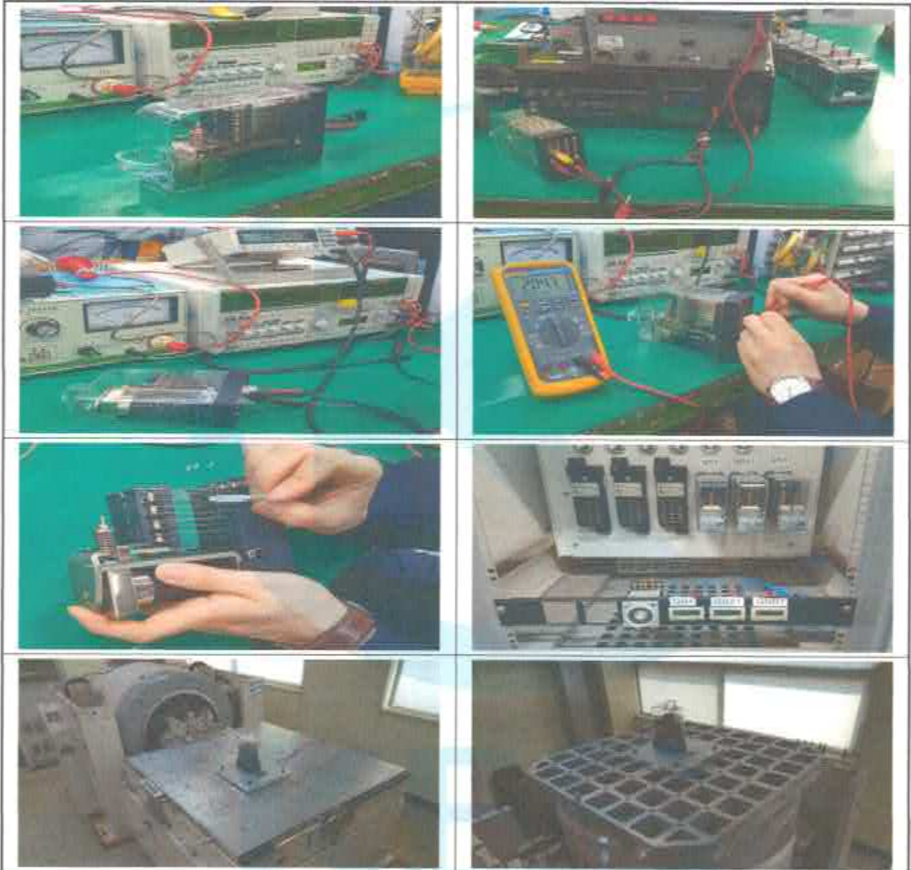
[ 신호시스템 제어용 계전기 QBA1형 시험 사진 ]
