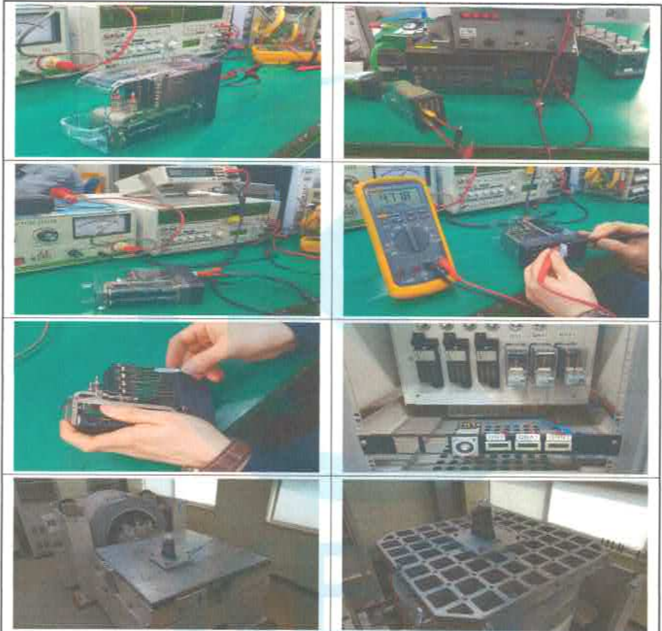
[ 신호시스템 제어용 계전기 QNN1형 시험 사진 ]
