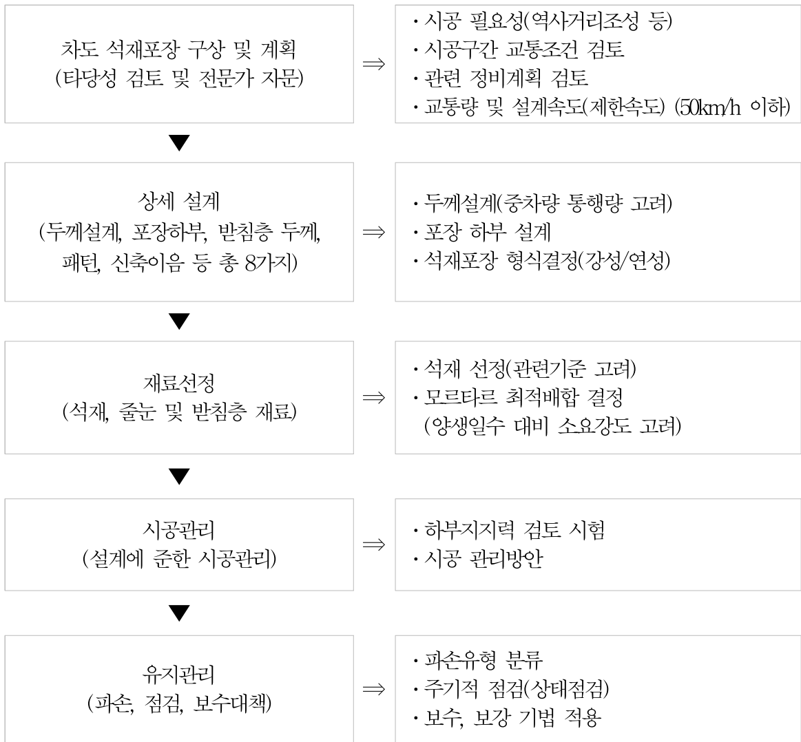
<그림 2.1> 석재포장 설계 시공 유지관리 흐름도
