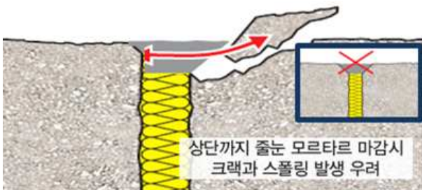
(c) 표층 상단까지 줄눈 시공 시 파손유형
