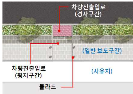
[그림 1] 차량진출입로 평면도
